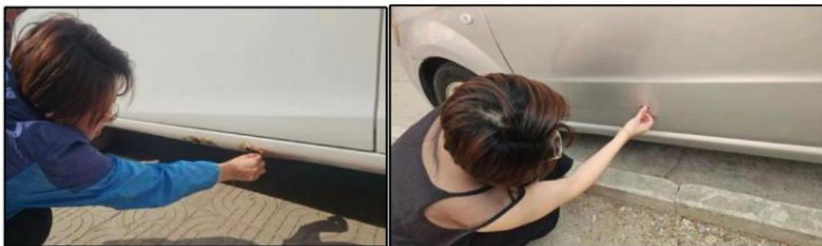
图 2 学习维修工艺，辨识碰撞与自然锈蚀痕迹
